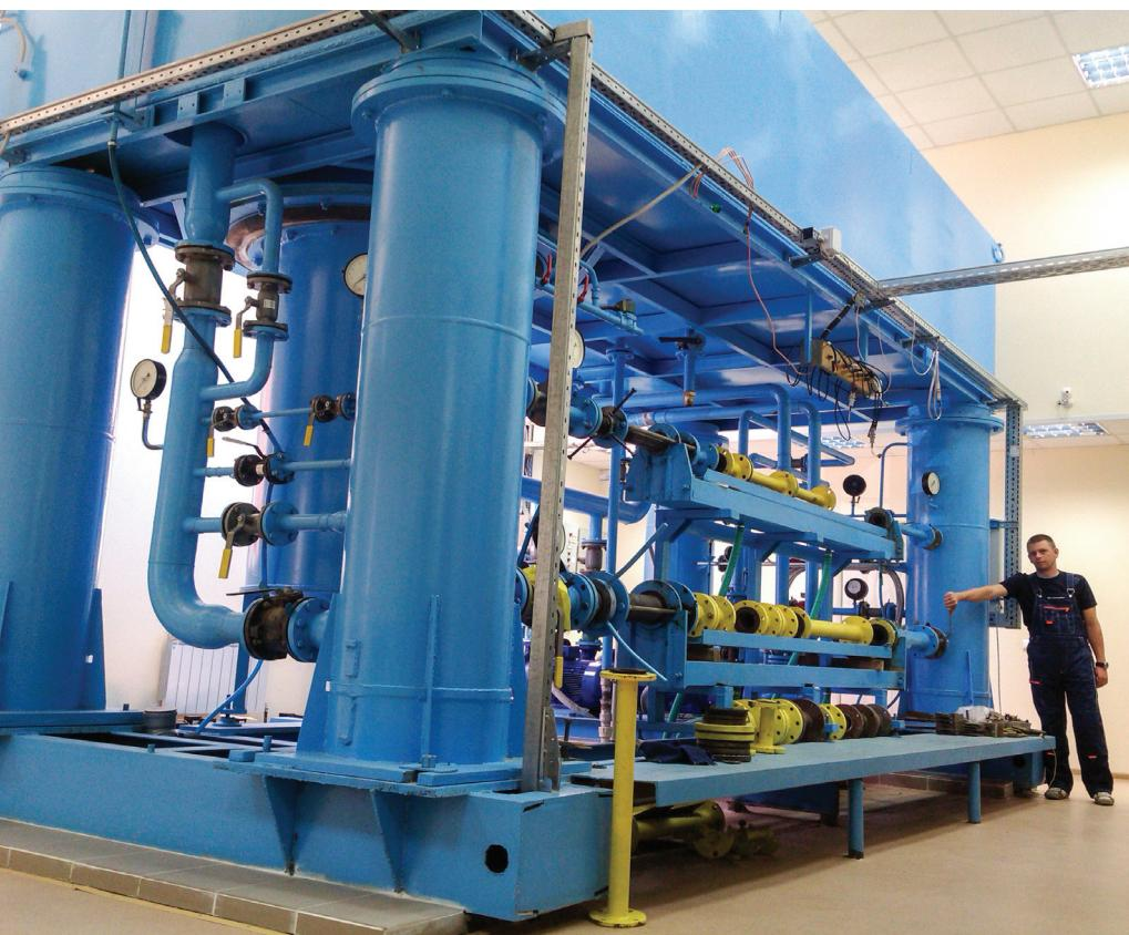
Единственная в крае проливная установка для приборов учета диаметром от 15 до 200 мм
